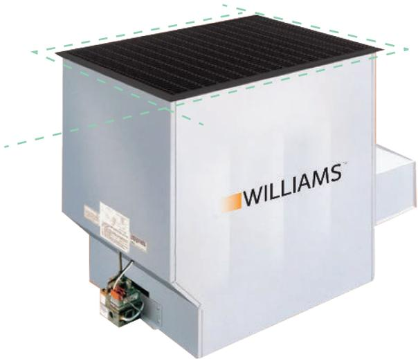
La cámara de combustión es de acero calibre 18, soldado con costura continua y formado con precisión, y tiene una garantía de 10 años contra oxidación o quemado. La carcasa exterior está construida de acero galvanizado de alta resistencia, traslapada y soldada por puntos para una mayor durabilidad.
